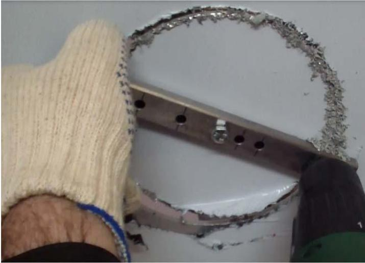
**В конце фрезеровки контролировать положение вырезаемой части. Совместить плоскость детали и вырезаемой части.**
