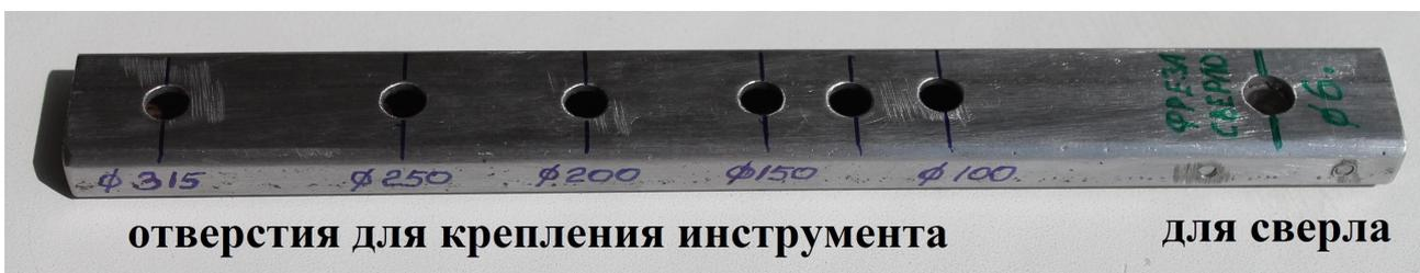
отверстия для крепления инструмента
