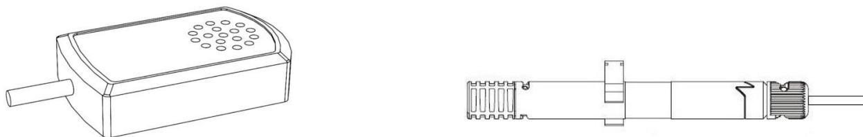
Рис. 3 Датчик влажности: комнатный (слева), канальный (справа)
