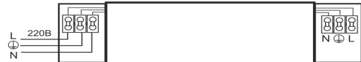
Рис. 4. Подключение СТЕП ПН к сети 220В
